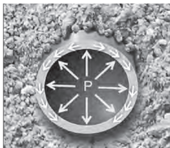
Innendruck – radiale Zugspannungen in der Rohrwand
