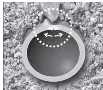
Äussere Punktlast – Spannungseintrag in die Rohrwand
